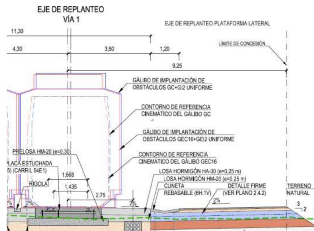
Figura 5. Sección tipo de la plataforma lateral
